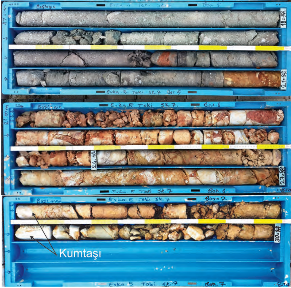
Şekil 13. SK-7 sondaj kuyusunda, 21 m derinliğinde aglomera-fily dokanağında gelişmiş oksitlenme-pişme nedeniyle meydana gelen pembe renkli breşik zon (F 3 fay zonu, 20.8 - 21.0 m arası fay kili ve 21.1 - 21.55 m arası da fay breşi olarak değerlendirilmiştir). Figure 13. In BH-7 borehole, down to 21 m from the ground surface, breccia zone with pink colour occurred due to oxidation and baking in the contact between agglomerate and flysch units.
